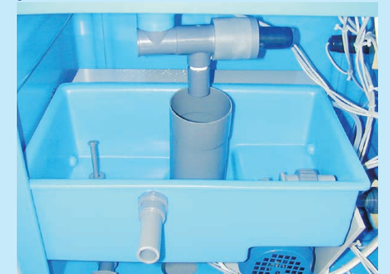
Particolare della vaschetta di miscelazione nella quale cade l'ipoclorito di calcio.
